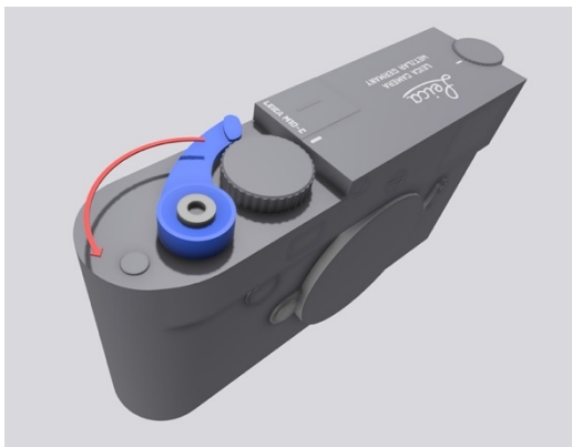
Abbildung 7: 130^\circ Umdrehung des Aufziehhebels (CAD-Programm Shapr3D)
