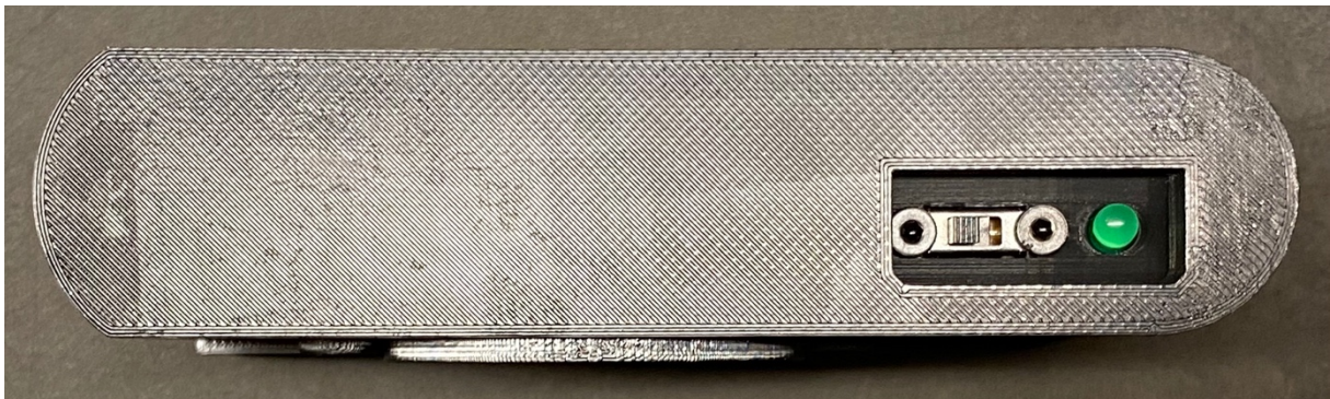
Abbildung 46: Unterseite der 3D-gedruckten Kamera mit Schalter und LED
