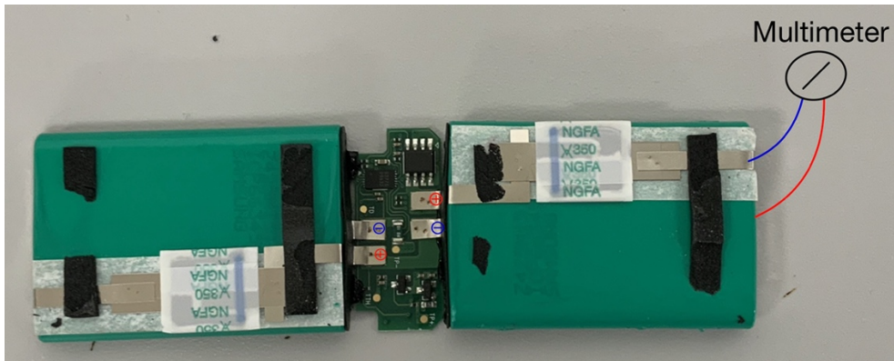
Abbildung 23: Auseinander gebauter Leica M10 Akku
